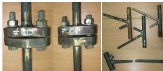
Rys. 14. Badania laboratoryjne śrub i spoin w złączach doczołowych oraz spoin pachwinowych stężeń (fot. Krzysztof Konecki)
